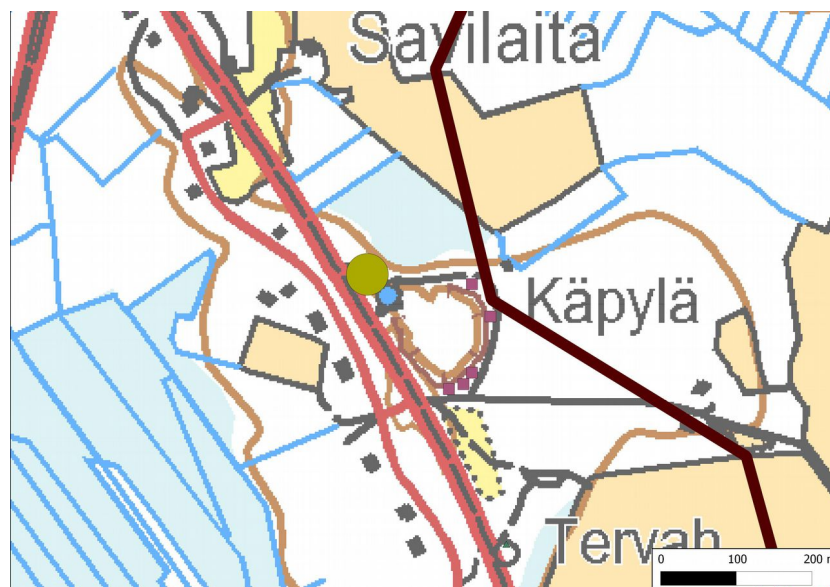
Kartta 11. Käpylä Pumppaamo, kohde merkitty ympyrällä. Hiekkakuopan reunamille tehdyt koepistot punaisilla neliöillä.
